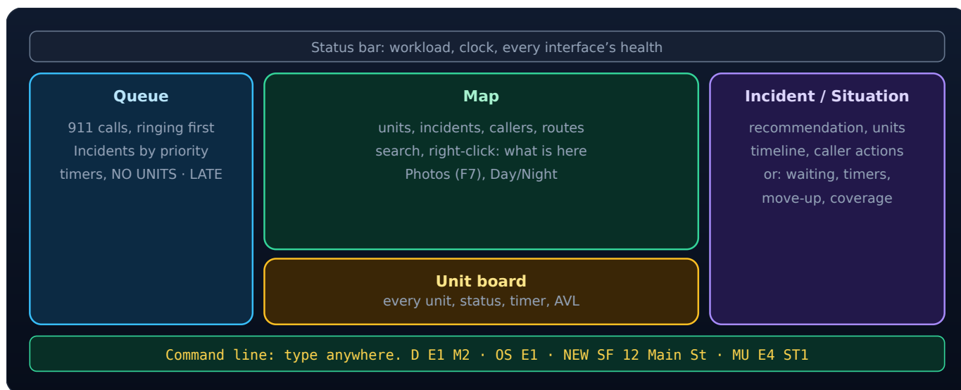
Kuva 2. Päivystäjän näyttö: puhelut ja tehtävät vasemmalla, kartta keskellä, valittu tehtävä oikealla
